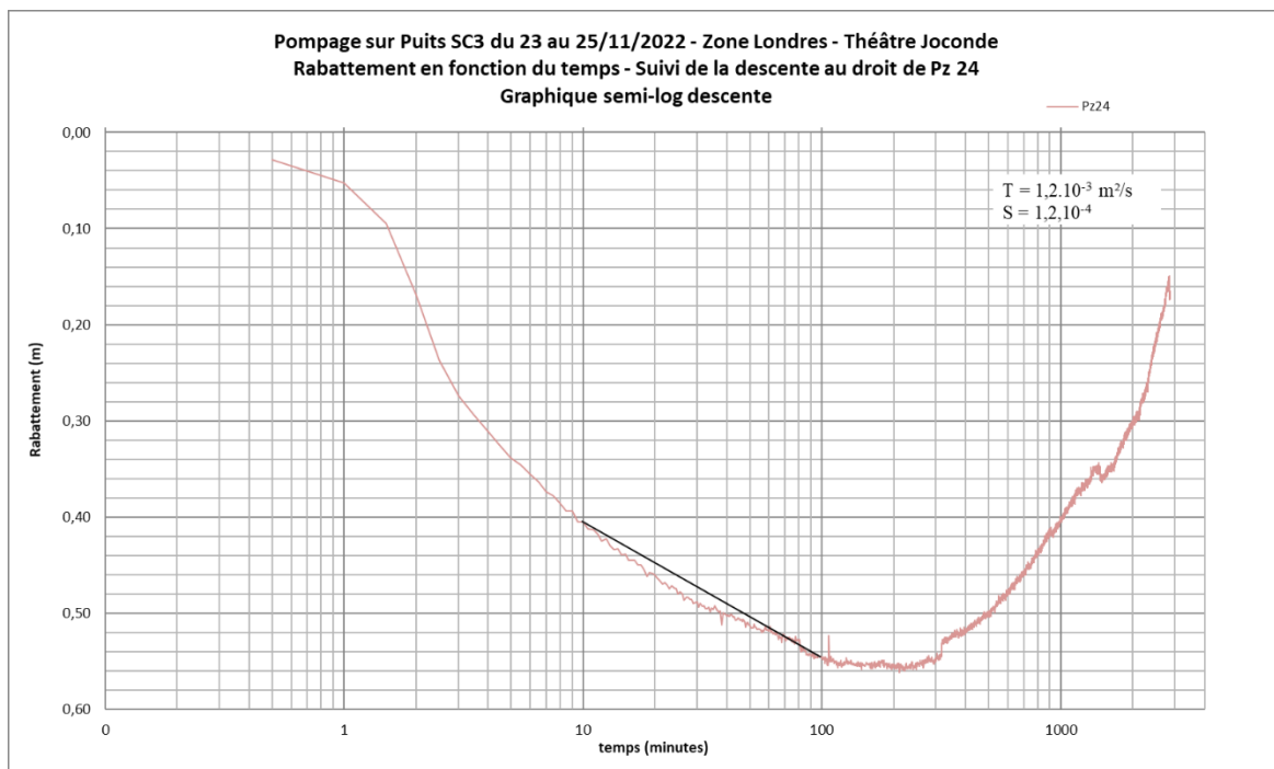
Figure 12 : Interprétation graphique du rabattement lors de la phase de descente au droit de Pz 24
